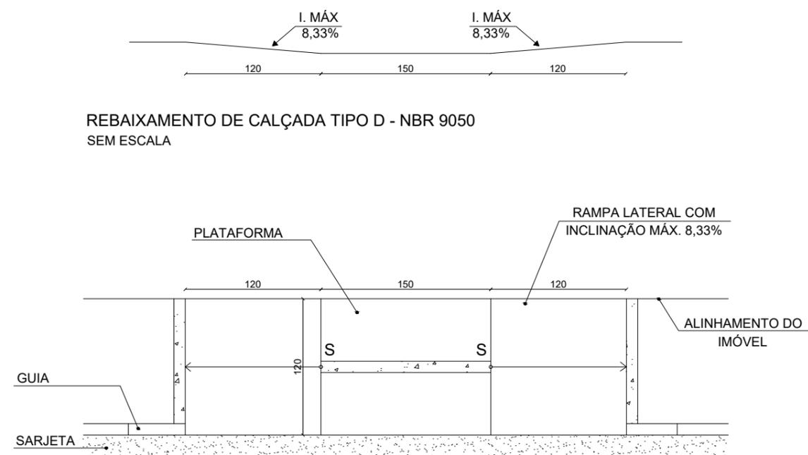
REBAIXAMENTO DE CALÇADA TIPO D - NBR 9050 SEM ESCALA
