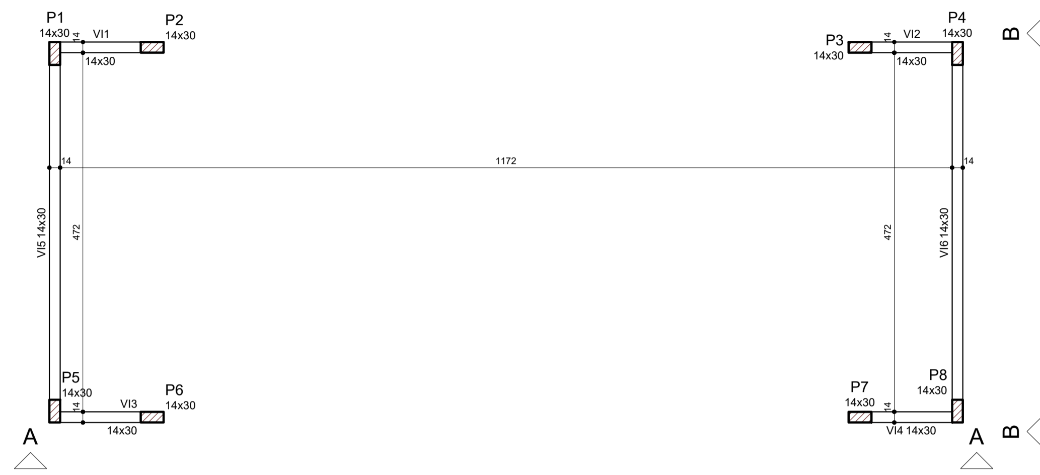
FÔRMA INTERMEDIÁRIA DO PVTO. MESA SUPERIOR (NÍVEL 120) ESCALA 1:50
