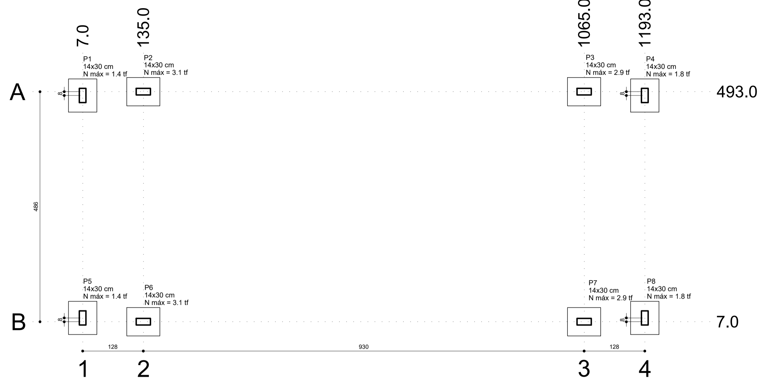
PLANTA DE LOCAÇÃO ESCALA 1:50
