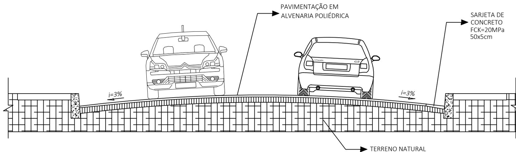
TÍTULO: PAVIMENTAÇÃO E ALVENARIA POLIÉDRICA - CORTE TRANSVERSAL - INCLINAÇÃO DE PISTA
